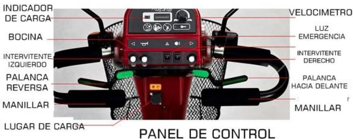
**Interruptor Clave:** Gire la llave en el sentido de las agujas del reloj para manejar el scooter. Para apagar el scooter en sentido contrario a las agujas del reloj.
